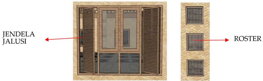
Gambar. 8 ventilasi alam temporer
