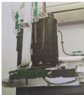
Gambar 3. 21 Kompresor Terpasang pada Braicket dan Papan Panel
